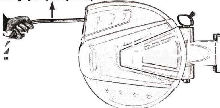
2. Bitte ziehen Sie nicht am Schlauch, wenn dieser seine maximale Länge erreicht hat (die gelbe Markierung auf dem Schlauch zeigt das Ende an).
