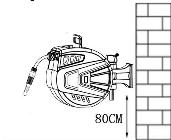
Es wird empfohlen, die Montagehalterung 0,8 Meter vom Boden entfernt zu installieren.
