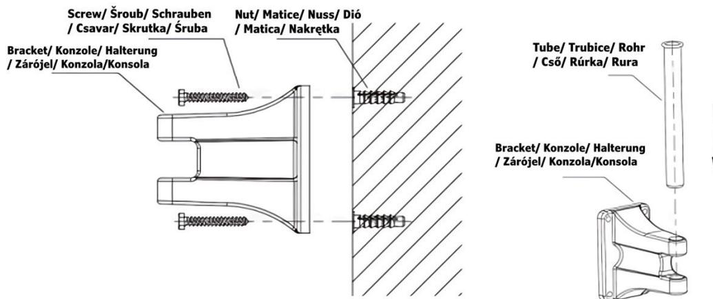
1. Bohren Sie 4x M8-Löcher passend zu den Löchern in der Montagehalterung.
