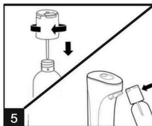
Na hrdlo láhve nasadte plnicí ventil, pootoče jím po směru hodinových ručiček a láhev uzavřete. Láhev s plnicím ventilem nasadte na úchyt pro plnicí ventil a sklopte.
