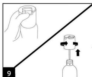
Pokud je uzávěr pro pomalé odvzdušnění otevřen a zvuk sycení ustane, stiskněte modré tlačítko pro rychlé odvzdušnění a ujistěte se, že tlak je zcela uvolněný. Sejměte plnicí ventil pootočením proti směru hodinových ručiček.
