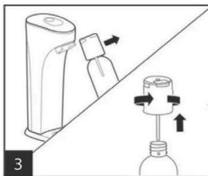
Láhev vykloňte směrem k sobě a vysuňte z výrobniku. Plnicí ventil pootoče proti směru hodinových ručiček a sejměte jej z láhve.
