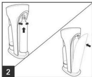
Pro nasazení CO<sub>2</sub> bombičky, vložte závitovou část bombičky do přístroje, našroubujte a utáhněte. Nasadte zadní víko.
