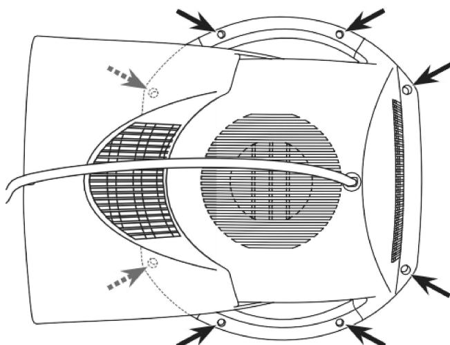
3. Zostavte kryt a prednú časť s keramickým skleneným diskom nechajte na základni.
