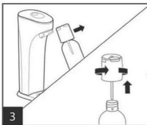
Fľašu vykloňte smerom k sebe a vysuňte z výrobníku. Plniaci ventil pootočte proti smeru hodinových ručičiek a zložte ho z fľaše.
