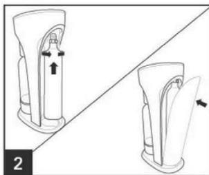
Pre nasadenie CO<sub>2</sub> bombičky vložte závitovú časť bombičky do prístroja a utiahnite. Nasadte zadné veko.
