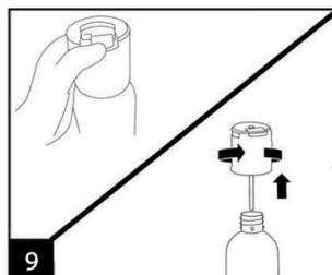
Pokiaľ je uzáver pre pomalé odvzdušnenie otvorený a zvuk sýtenia ustane, stlačte modré tlačidlo pre rýchle odvzdušnenie a uistite sa, že tlak je úplne uvoľnený. Zložte plniaci ventil pootočením proti smeru hodinových ručičiek.
