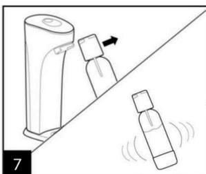
Fľašu s pripravenou sódou vykloňte, vysuňte z výrobníka a opatrne pretrepte fľašu, aby sa zvýšilo nasýtenie nápoja.
