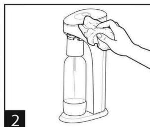
Ak chcete vyčistiť výrobník, utrite ho vlhkou handričkou. Neponárajte ho do vody, nepoužívajte žiadne rozpúšťadlá ani abrazívne prostriedky, mohlo by to poškodiť povrch.
