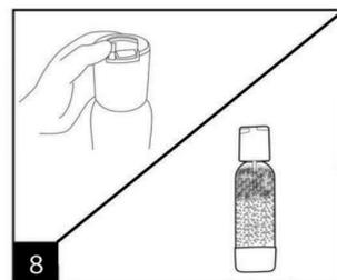
Otvorte uzáver pre pomalé odvzdušnenie a venujte pozornosť hladine peny pri uvoľňovaní tlaku. Pokiaľ pena dosiahne hornú časť fľaše, uzatvorte ventil s pomalým uvoľňovaním tlaku a počkajte, kým pena klesne a znovu otvorte. V takomto prípade nabudúce nápoj sýtíte menej.
